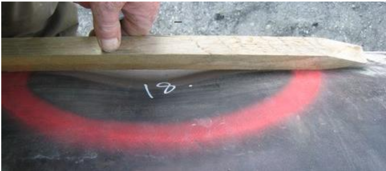
Myndin sýnir dæmi um álagsskemmd (dæld) á kápu hitaveitupípu.
